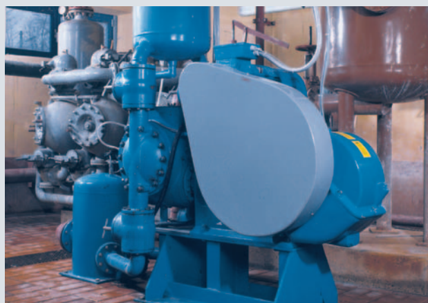
Diseño probado y estable. Bomba de pistón membrana ABEL CM para alimentación de filtros prensa
