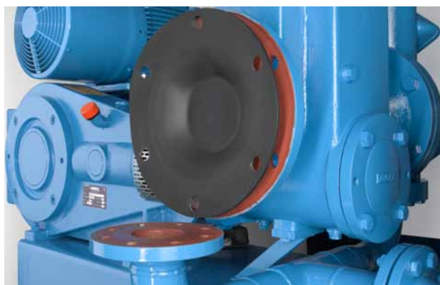
Die vorgeformte HM-Membrane wird während des gesamten Hubes keinerlei Dehnung unterworfen.
