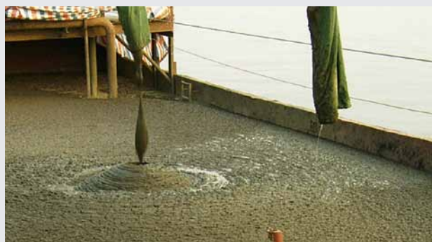
Eingedickter, ausgefallter Klärschlamm, TS-Gehalt 7 %
