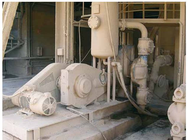
ABEL HM zur Förderung von eisenhaltigem Jarositschlamm
