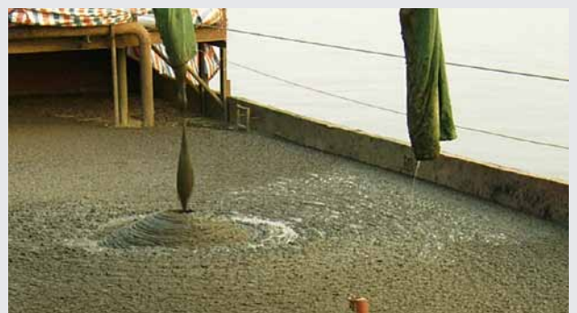
Eingedickter, ausgefalter Klärschlamm, TS-Gehalt 7 %
