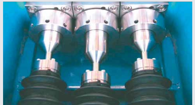
Die Faltenbalgabdichtung der ABEL HPT schützt das Getriebe zuverlässig gegen Schmutz- und Flüssigkeitseintritt
