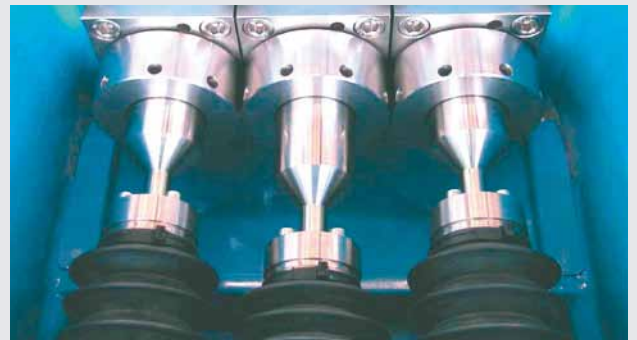
Die Faltenbalgabdichtung der ABEL HPT schützt das Getriebe zuverlässig gegen Schmutz- und Flüssigkeitseintritt
